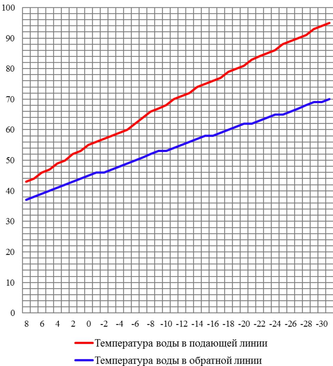
**Рисунок 4 – Графическое представление температурного графика**
